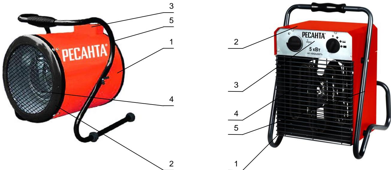
Несущая конструкция тепловой пушки (см. рис. 1) состоит из корпуса (поз.1) и крышки (поз. 2). Вентилятор расположен в задней части пушки. Блок управления смонтирован в верхней части корпуса. Органы управления вынесены на панель (поз.3). Трубчатые электронагреватели (ТЭНЫ) расположены внутри корпуса между вентилятором и решеткой (поз.4), закрывающей их клиновой стороны.
